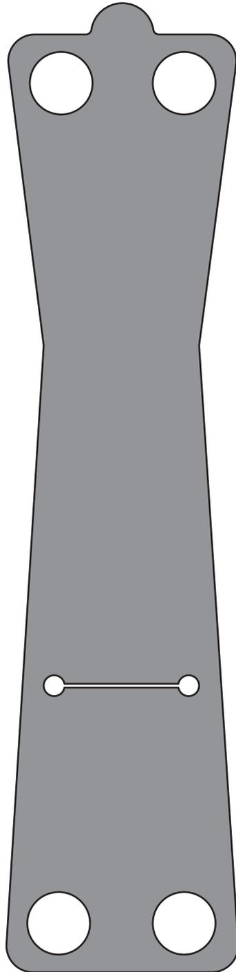
Schablonenvorlage für einen Smartphonehalter aus Fahrradschlauch
